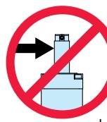
Der Standard ERD stangen geführte Stellantrieb ist nicht für Anwendungen vorgesehen, bei denen eine Seitenkraft auftritt. Wenn in der Anwendung Seitenkraft vorhanden ist, sollten Sie die Option GD2 Geführt in Betracht ziehen.
